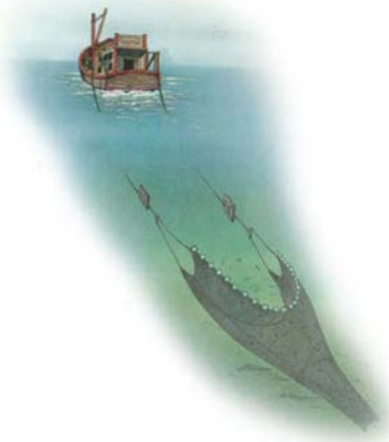
ภาพที่ ๑๔ ลักษณะการทำงานของเรือลากแผ่นตะเฒ่
