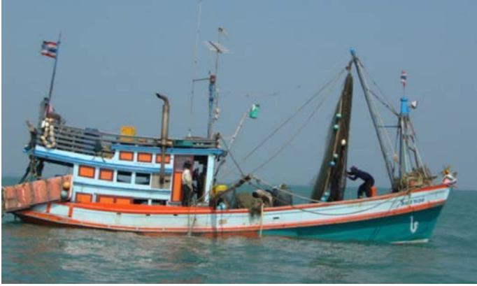
ภาพที่ ๑๐ ลักษณะของเรือประมงอวนลากแผ่นตะเฆ่
