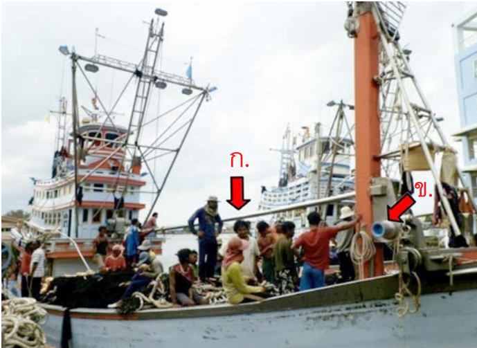
ภาพที่ ๒๒ ลักษณะของเรือประมงวนด้าที่ประกอบด้วยเสาขนานลำเรือ (ก) และกว้านหัวเรือ (ข)
